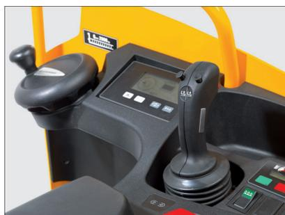
Manipulación de todas las funciones de marcha e hidráulica con la palanca multifunciones en ESE 220/320
