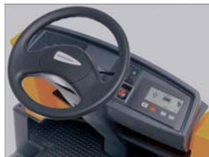
Elementos de mando dispuestos claramente para un control fácil del remolcador
